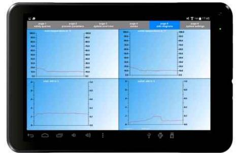
Le contrôle et la surveillance sont gérés par une PLC connectable par Ethernet, WLAN et GSM à partir d'un appareil mobile comme une tablette ou un smartphone.
