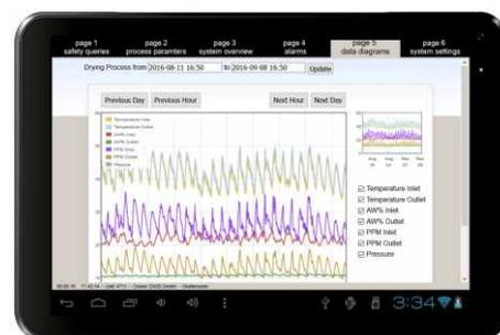
Le contrôle et la surveillance sont gérés par une PLC connectable par Ethernet, WLAN et GSM à partir d'un appareil mobile comme une tablette ou un smartphone.
