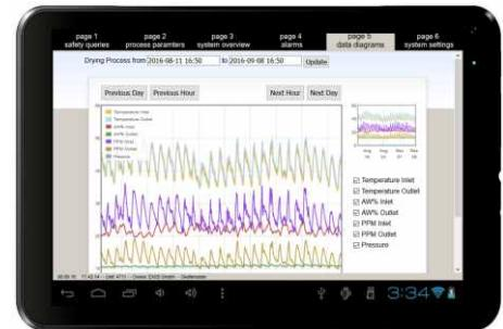
El control y el monitoreo de ATMoS se dan a través de un PLC, el acceso puede efectuarse vía Ethernet, WLAN o una conexión GSM a partir de dispositivos móviles, tales como tabletas o smartphone.
